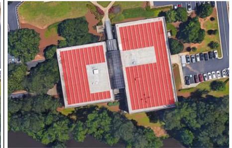
\* Área Total estimada de cubierta usada para paneles FV = 27.017 ft2 (2.510 m<sup>2</sup>)
